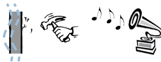
Trasmissione per via strutturale
